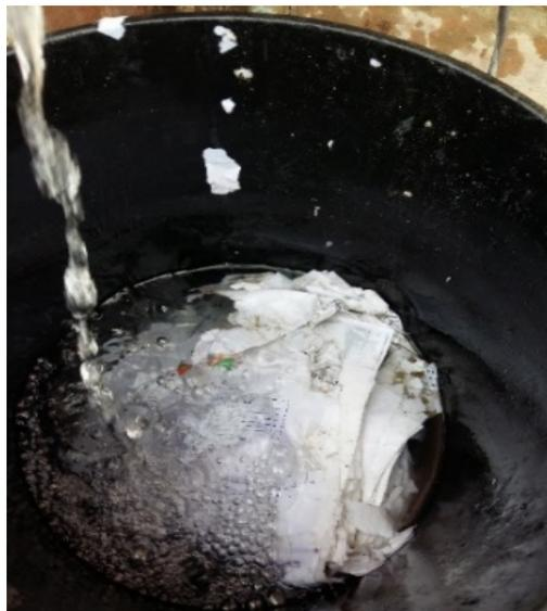
Utilizando una batidora Hobart se procedió a homogenizar el papel bond de 75gr. triturándolo y adicionando agua hasta conseguir una consistencia uniforme, tal como se observa en la Figura 3.
