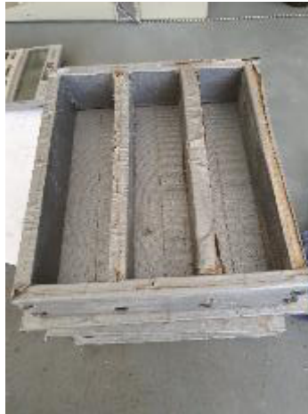
Figura 11. Molde para la prueba de flexión
