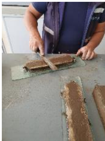
Figura 18. Probetas de ensayo de tensión
