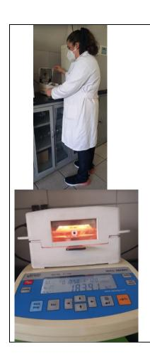
Mediante el Analizador RADWAG se determinó la humedad en de las muestras por triplicado. El equipo fue programado con perfil de secado estándar a 120º C y en el modo de determinación automática.
