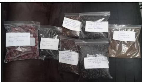
Las muestras de las diferentes etapas de los procesos empleados se arreglaron en triplicado; almacenándolas a temperatura ambiente en bolsas plásticas para ser transportadas hasta el punto en que serían analizadas.
