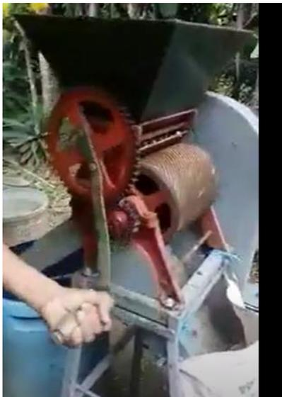
El despulpado se realiza mediante una máquina que en húmedo separa el grano de café (producto) de la pulpa (subproducto); siendo la última el insumo para esta investigación.
