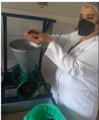
Operación unitaria que sirve para reducir de tamaño la pulpa seca hasta pulverizarse. Se trata de realizar una molienda fina para la obtención de harina caracterizada por su fácil mezclado con cualquier otro tipo de cernido comestible para lograr fabricar galletas, pan, y pastas, entre otras.
